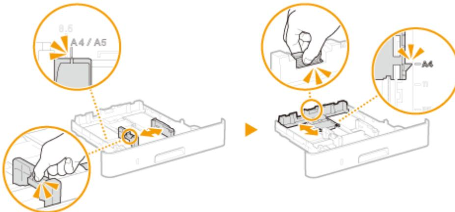
**3 Legen Sie das Papier so ein, dass die Kante des Papierstapels an der Papierführung an der Rückseite der Papierkassette ausgerichtet ist.**
